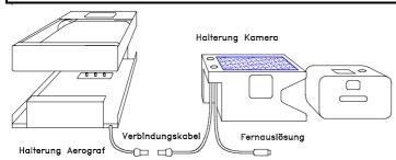
Der Aerograf 2000 und die dazugehörige Zeitkamera haben je eine 5-Pol Buchse eingebaut. In den jeweiligen Halterungen sind die entsprechenden Stecker angebracht, so dass beim Einschieben der Geräte die Verbindung Aerograf 2000 / Zeitkamera über ein Kabel automatisch hergestellt wird. Das Herstellen oder Unter-
