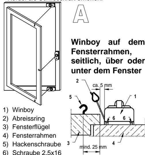
**Achtung:** Damit die Abreissicherung richtig funktioniert, muss die Hackenschraube mindestens 25 mm von der Fensterkante entfernt montiert werden.
